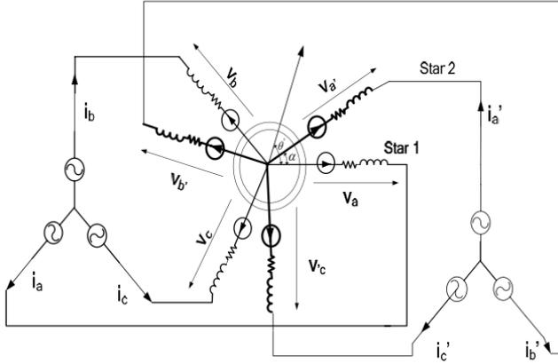
Fig. 1. Equivalent DSIM scheme.
